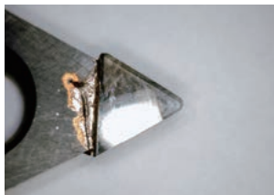
曲面加工した刃先の実態像 (左) と刃先の電子顕微鏡 (SEM) 像 (右)
