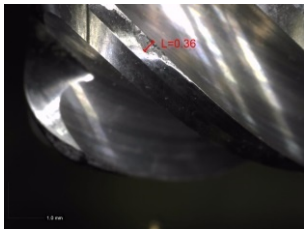
写真7 エンドミル外周逃げ面の磨耗幅を測定
