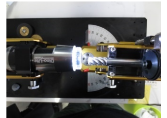
写真9 エンドミル底刃の逃げ面磨耗幅を測定
