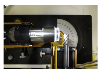
写真11 ラディアスエンドミルR刃の逃げ面磨耗幅を測定
