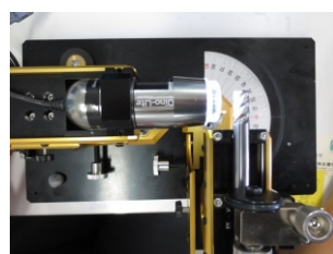
写真8 エンドミル外周すくい面磨耗幅を測定
