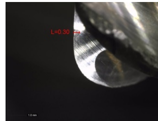
写真10 エンドミル底刃のすくい面磨耗幅を測定
