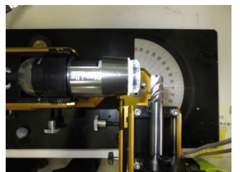
写真10 エンドミル底刃のすくい面磨耗幅を測定
