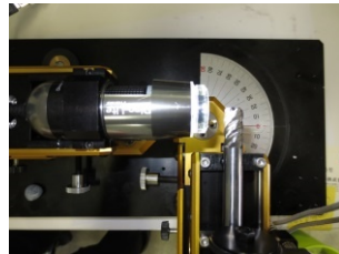
写真7 エンドミル外周逃げ面の磨耗幅を測定
