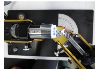
写真11 ラディアスエンドミルR刃の逃げ面磨耗幅を測定
