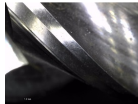
写真15 エンドミル 直径: 10 / 倍率: 40倍 / 焦点距離: 15mm
